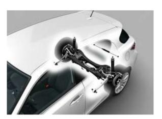
A pesar de aportar mayor rigidez, no se penaliza la transmisión de vibraciones a la carrocería y por lo tanto al conductor, debido al amortiguador de Aceite-Nitrógeno a alta presión.
